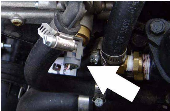
6. 从 LPG 燃料温度传感器上拆下固定夹，然后从调节器本体上拆下传感器。
